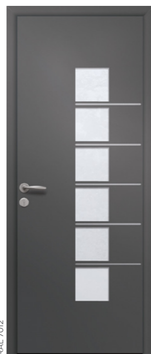
ORTHOSIE 6 Triple vitrage dépoli acide Décors alunox inclus 2 faces U b : 1,3 W/m 2 .K
