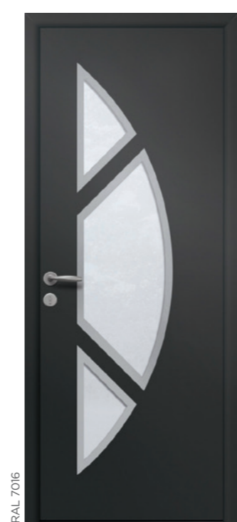
GOYA 3 Triple vitrage dépoli acide Décors alunox 2 faces en option U b : 1,3 W/m 2 .K
