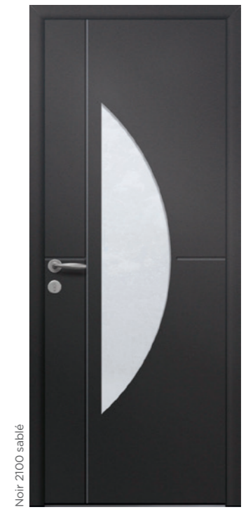
LAVANDE 1 Triple vitrage dépoli acide Décors rainurés 2 faces U b : 1,3 W/m 2 .K
