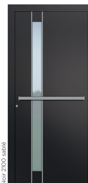
MEDITATION AS-V2 Quadruple vitrage feuilleté dépoli acide Barre de tirage toute largeur en inox brossé et joncs alunox U_D = 0,94 \text{ W/m}^2.K
