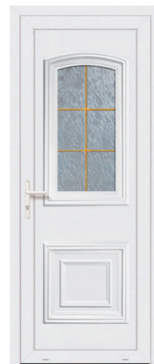
CALVI 1L Double vitrage delta clair Croisillons laiton en option U b : 1,7 W/m 2 .K
